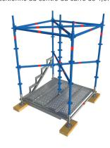
4 Monter les 2 diagonales de 2 m, le limon suivant et les diagonales d'1,57 m (réf. selon le schéma).
