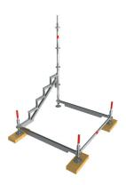
Positionner la poutrelle U à U réf. : 2600.157, centrée sur les 2 poutrelles, puis le goujon réf. : 2656.002, centré sur la poutrelle U à U. Placer ensuite les 4 planchers 1,57 x 0,32, puis les joints de sécurité.
