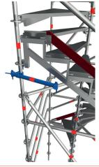
**7** La norme NF-P-93523 impose un palier de repos toutes les 25 marches. Le palier est constitué de 2 demi-paliers (réf. : 0732.815 (G) - 0732.816 (D)). Veiller à mettre en place le support plancher pour monter le palier comme suit :
