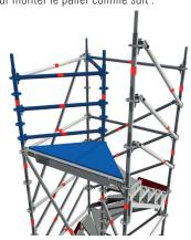
Montage du dernier niveau. Lorsque le dernier limon est face à la dalle à desservir, terminer la structure par 3 montants d'1 m (réf. : 2646.100) et 2 montants à 5 coupelles. Positionner alors les 3 moises de 1,13 m pour sécuriser la dernière marche.
