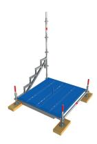
Placer les 4 montants de 2 m sur les embases et 1 rangée de moise de 1,57. Puis à l'aide des moises de 1,13 m (réf.: 0732.443) positionner le montant de 2 m à 10 coupelles (réf.: 0732.442) sur le goujon. Il sera ainsi automatiquement vertical et positionné au centre du carré de 1,57 x 1,57.
