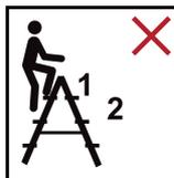
Ne pas monter sur les deux derniers barreaux d'une échelle double sans une plateforme et un appui (main ou genou)
