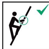
Une prise en main ferme est nécessaire (montées, descentes et travaux).
