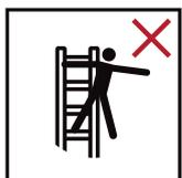
Ne pas se pencher à l'extérieur de l'échelle.
