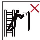
Ne pas s'appuyer fortement d'un seul côté (par exemple pour perforer du béton).
