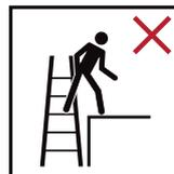
Ne pas utiliser l'échelle pour passer d'un niveau à un autre.
