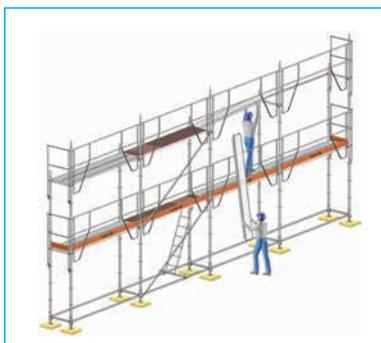
(7) Mise en place des planchers du 2<sup>e</sup> étage à partir du 1<sup>er</sup> étage.
