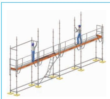
(4) Accès au 1<sup>er</sup> étage et mise en place des montants et des plinthes du 1<sup>er</sup> étage.
