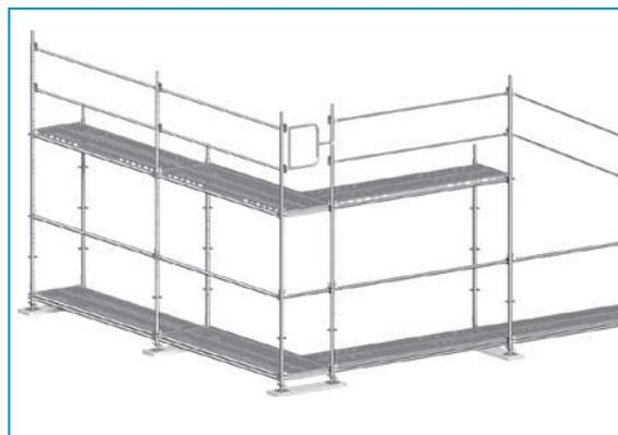
Un garde-corps d'extrémité et une poutrelle U sont utilisés pour les angles extérieurs.
