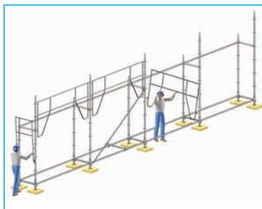
(2) Mise en place des garde-corps de sécurité définitifs (façade et retour) du 1<sup>er</sup> étage. Le contreventement évite le déversement.
