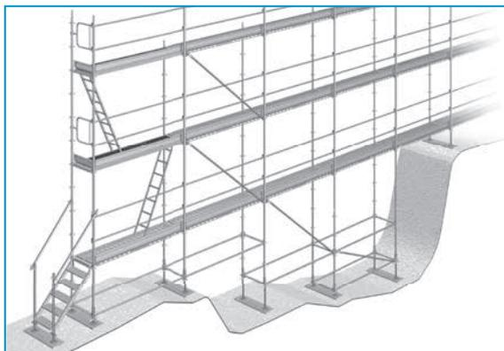
La compatibilité avec l'Universel permet l'adaptation au terrain rapide et facile.
