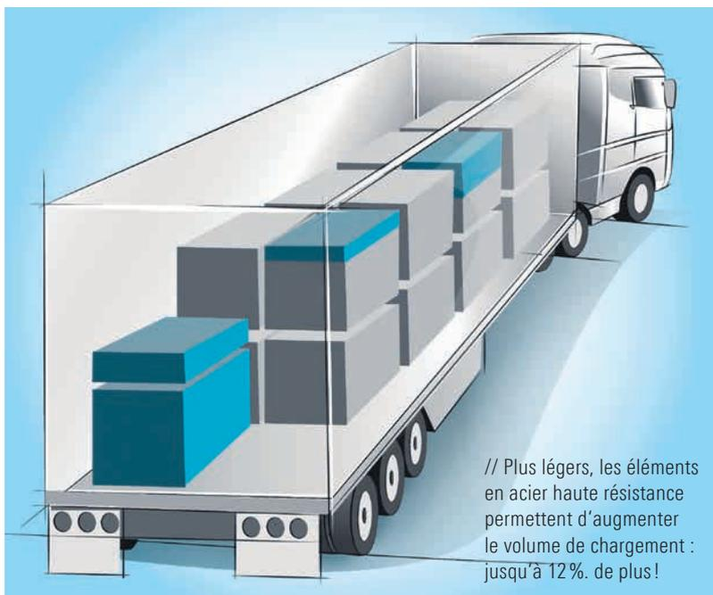
// Plus légers, les éléments en acier haute résistance permettent d'augmenter le volume de chargement : jusqu'à 12% de plus!
