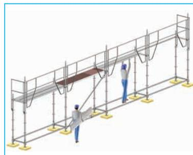
(3) Mise en place des planchers du 1<sup>er</sup> étage.
