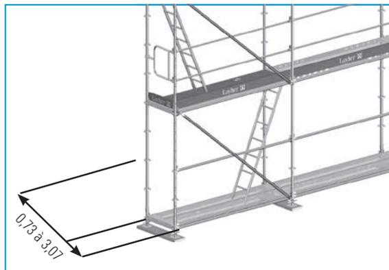
La largeur du plancher peut être modulable, en utilisant les éléments Universel standard.
